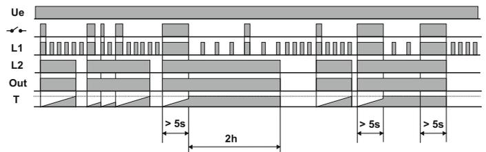
Modo Flip - Flop a la conexión de un pulsador
