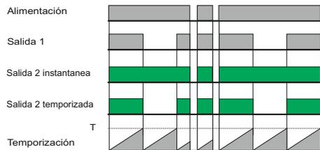
Al conectar a red se excita el relé y se inicia la temporización, al alcanzar el valor predeterminado "T", se desconecta el relé, iniciándose en ese momento un proceso de estados cíclicos de conexión y desconexión del relé, ambos con el mismo tiempo. La puesta a cero se realiza siempre al desconectar de red.
