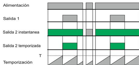
Al conectar a red se inicia la temporización, al alcanzar el valor predeterminado "T", se excita el relé, iniciándose en ese momento un proceso de estados cíclicos de conexión y desconexión del relé, ambos con el mismo tiempo. La puesta a cero se realiza siempre al desconectar de red.
