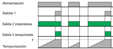
Al conectar a red se inicia la temporización, al alcanzar el valor predeterminado "T", se excita el relé, quedando conectado hasta que se produzca un corte de alimentación. La puesta a cero se realiza siempre al desconectar de red.
