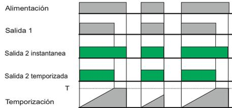
Al conectar a red se excita el relé y se inicia la temporización, al alcanzar el valor predeterminado "T", se desconecta el relé. La puesta a cero se realiza siempre al desconectar de red.
