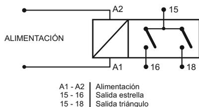
Temporizador arranque estrella - triángulo
